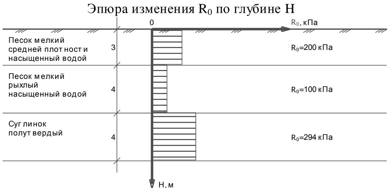
Рис. 2.12. Эпюра изменения расчётного сопротивления ( $R_0$ ) отдельных слоёв грунта по глубине ( $H$ ) рассматриваемого геологического разреза
