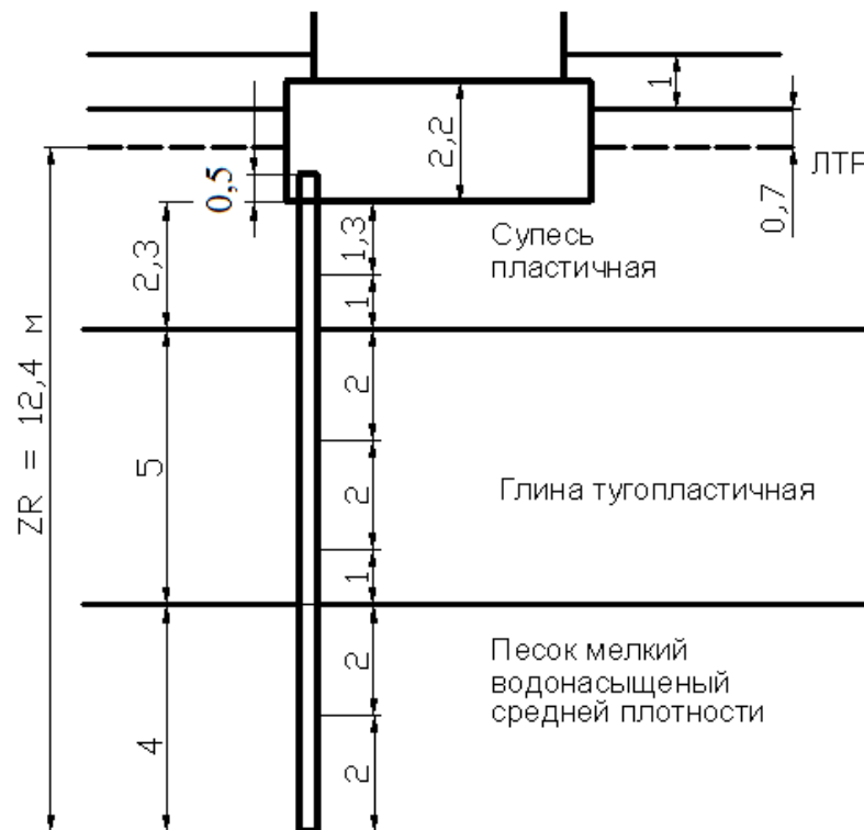
Рис. 24. Схема к определению размеров и несущей способности сваи
