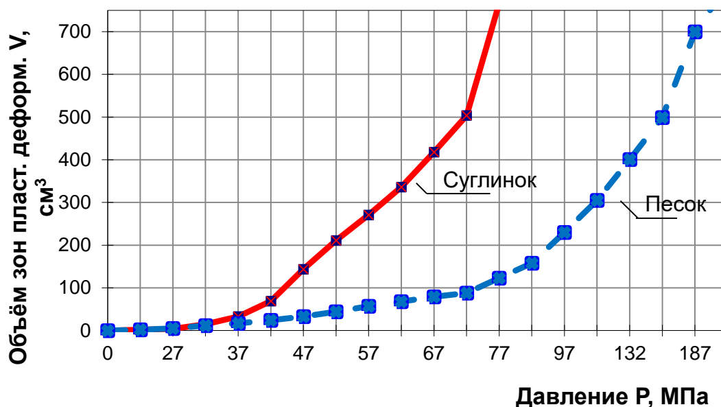
Рис. 1.3. График изменения объёма зон (областей) пластических деформаций ( V ) при увеличении давления ( P ) в основании жёсткого фундамента (плоская задача МКЭ).
