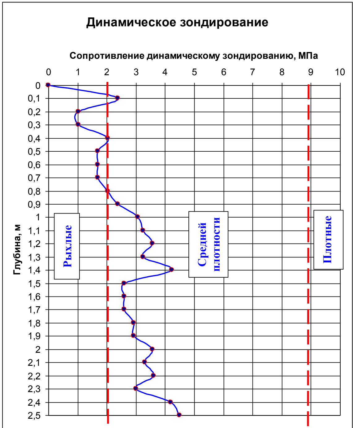
Рис. 2.4. Пример представления обработки результатов динамического зондирования с 10 см шагом по глубине основания.
