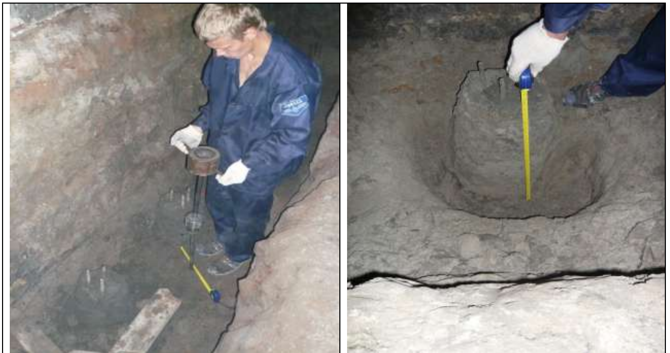
Рис. 3.12. Фотографии проведения качества изготовления микро свай усиления основания, с использованием метода динамического зондирования и прямого метода измерения головы частично откопанной сваи.
